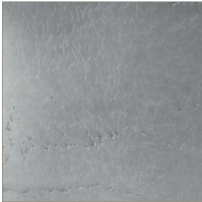
Wärmebeton mit Carnaubawachs eingelassen
