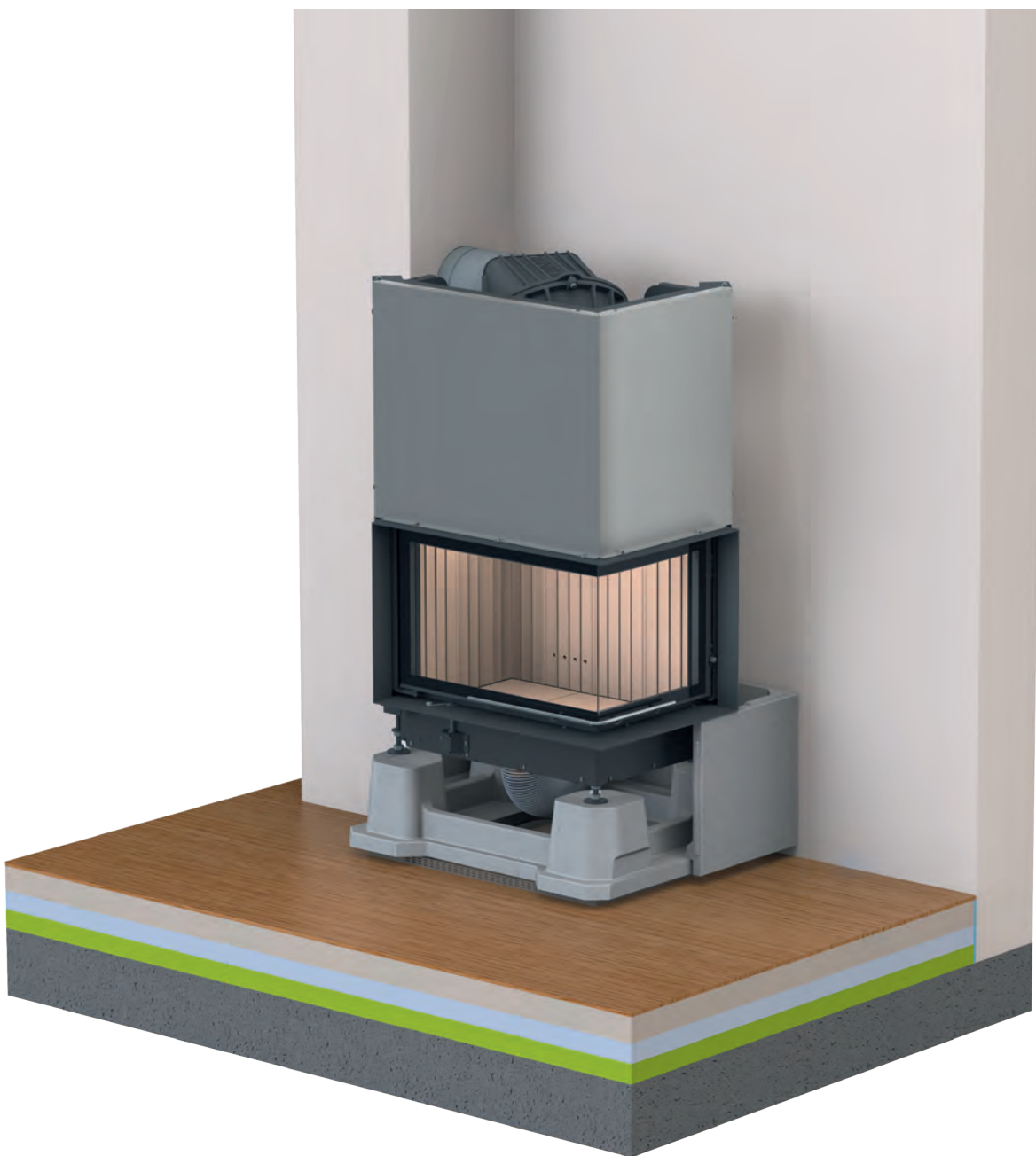
BSK 02 – nach Ausrichten der Grundplatte wird das untere Hüllenelement im Eckbereich gesetzt und der Durchgang für die Verbrennungsluftleitung erstellt. Danach werden der Kamineinsatz und die nachfolgenden Ringelemente aufgesetzt.
